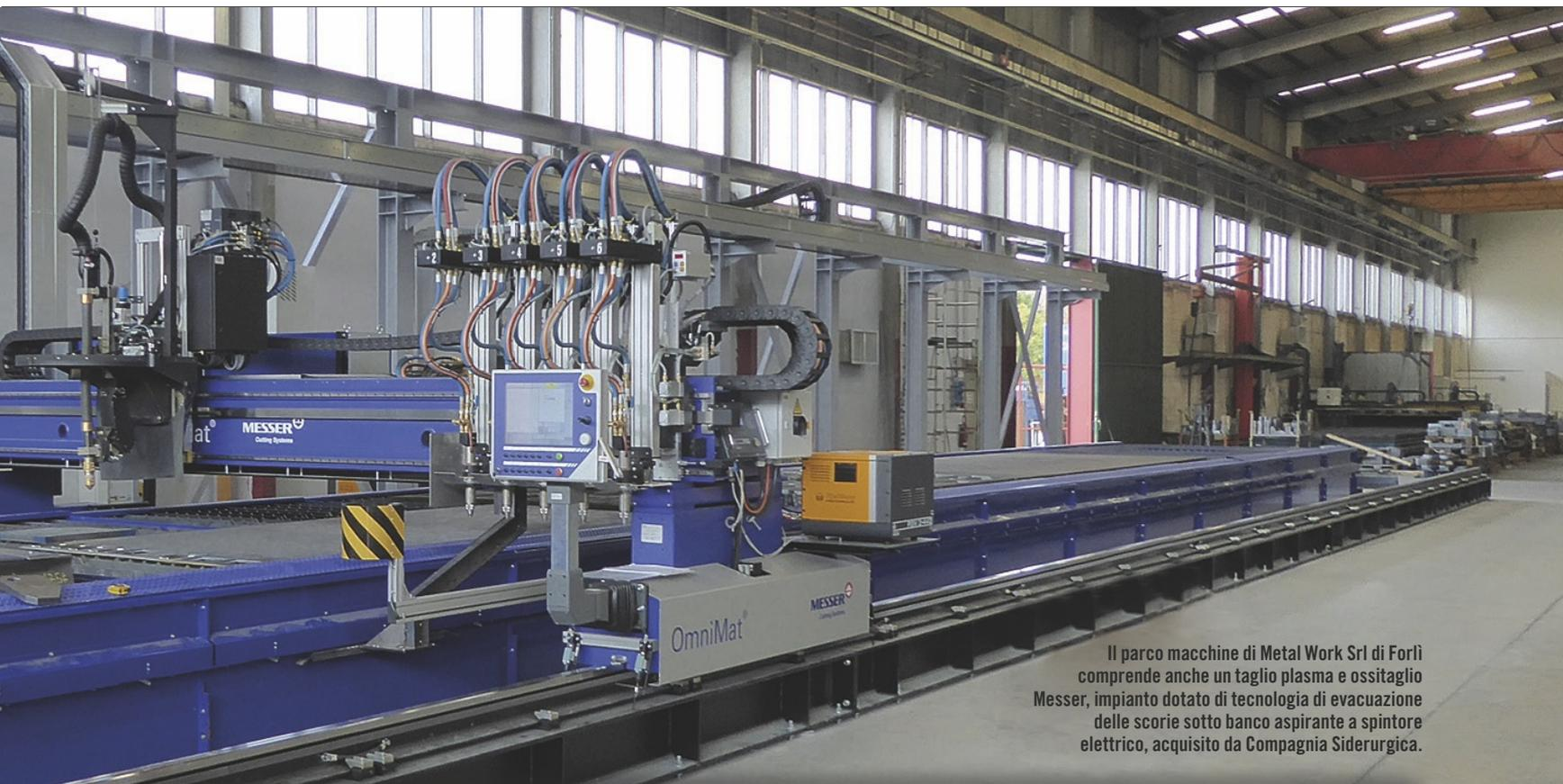
Il parco macchine di Metal Work Srl di Forlì comprende anche un taglio plasma e ossitaglio Messer, impianto dotato di tecnologia di evacuazione delle scorie sotto banco aspirante a spintore elettrico, acquisito da Compagnia Siderurgica.
