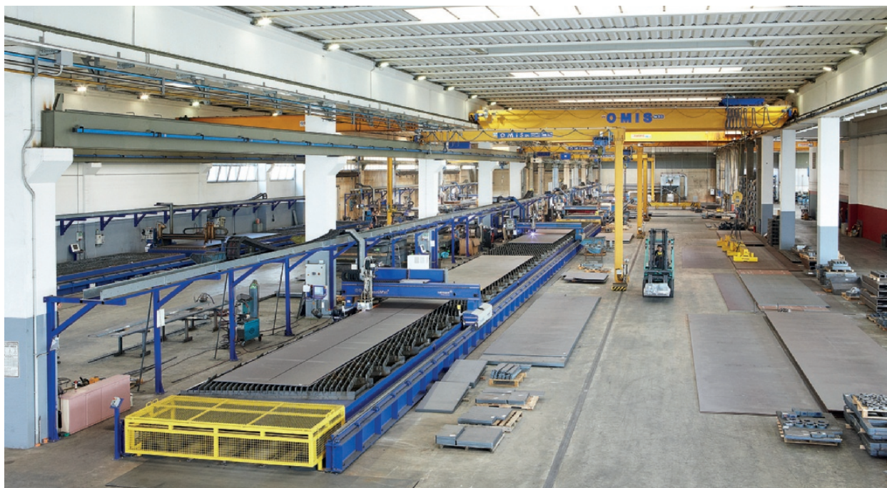
La sezione taglio termico di compagnia siderurgica conta 6 macchine a ossitaglio e cinque macchine di taglio plasma (ritratte nell'immagine) ognuna servita con tavoli aspiranti autopulenti di 24 metri. Sono presenti anche due impianti per il taglio laser da 4 e 6 kW.
